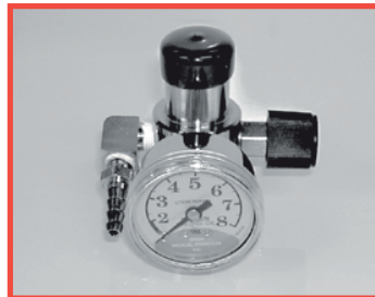
No. 1309A Regulador de flujo ajustable (2 - 8 LPM) con rosca CGA-540, fácil de atornillar manualmente a las válvulas Mada en el cilindro. También disponible como 1309A-1 (1/16 - 1 LPM), 1309A-5 (1/2 - 5 LPM) y 1309A-15 (2 - 15 LPM).
